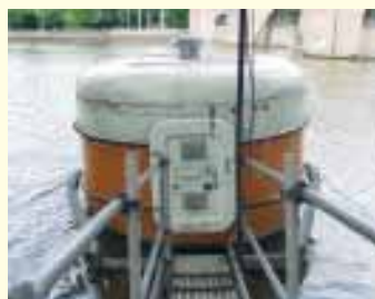
Kontinuierlich arbeitende Messtast der LUBW in Stuttgart-Hofen. Die Daten werden zur LUBW fern übertragen und sind im Internet einsehbar.
